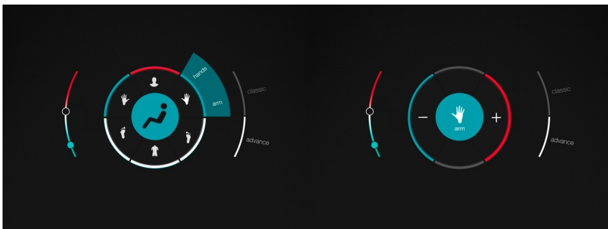
Obr. 7 Režim Advanced – lokální tepelný komfort: ruce, hlava apod. (vlevo), menu pro nastavení požadovaného tep. pocitu na ruku (vpravo).
