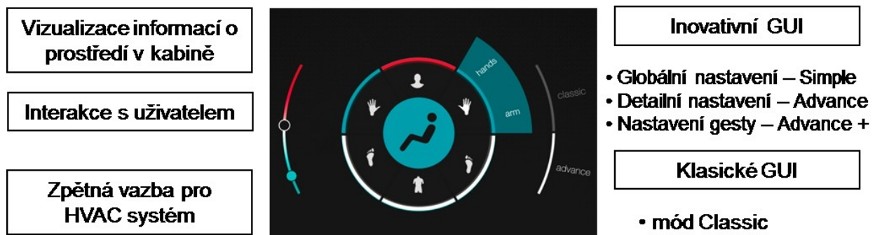
Obr. 1 - Aplikace RAVEC s vizualizací celkového ale i lokálního tepelného komfortu
