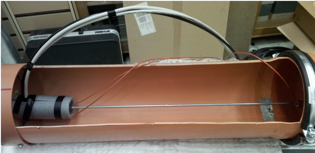
Pohled do zkušební sekce s instalovaným kanálem
