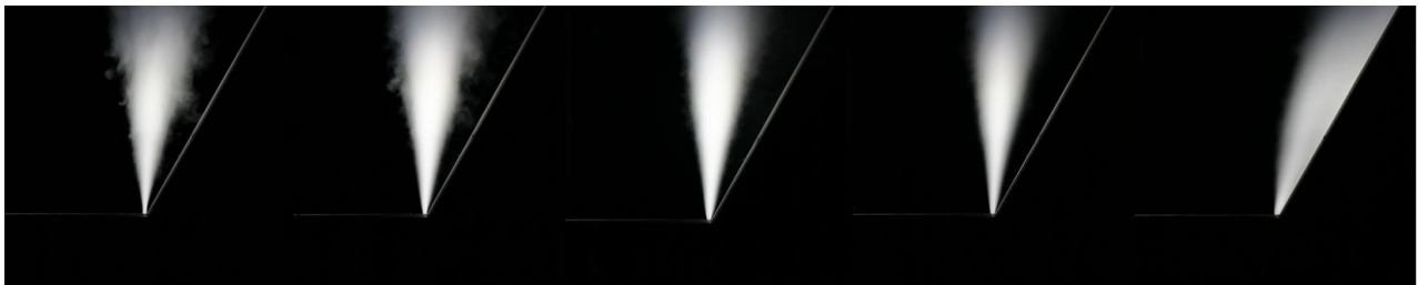
Obr. 2: Ukázka vizualizace odklonu proudu pro úhel odklonu desky 60° a rychlosti 2, 4, 6, 8 a 10 m/s, [3].
