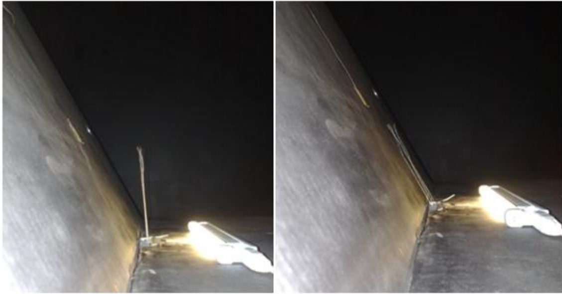
Obr. 4: Vizualizace nitovou metodou. Vlevo při nižších rychlostech nedochází ke Coandovu jevu, vpravo je vyšší rychlost proudu a Coandův jev lze pozorovat [3].
