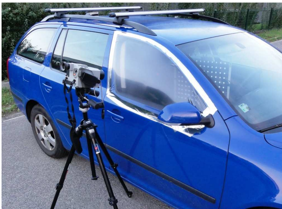
Obr. 1 Fotografie zařízení pro termovizní měření teplotních polí ve vzduchu v kabině automobilu skrz průzor
