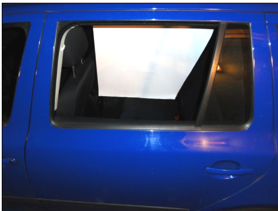
Obr. 2 Fotografie umístění pomocného materiálu při měření 2D neizotermního vzduchového proudu na zadních sedadlech automobilu v ose středové vyústky
