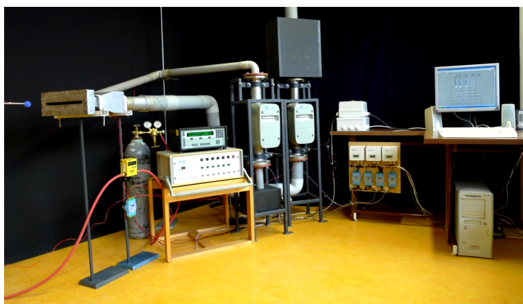
Obr. 1 Zařízení pro testování a výzkum sacích nástavců.
