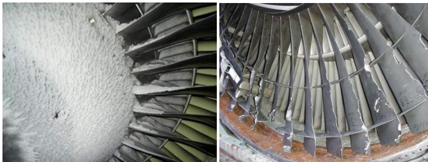
Obr. 2 Námraza na prvom stupni osového kompresora motora a jej dôsledky
