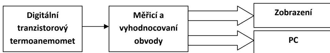
Obr. 2.: Měřicí zobrazovací a komunikační obvod pro digitální tranzistorový termoanemometr
