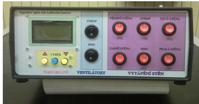
Obr. 4.: Regulátor teplot stěn kalibrační komory
