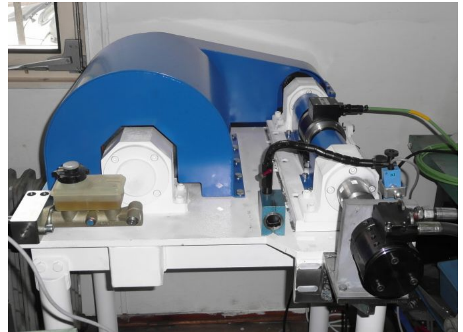
Schéma zkušebního zařízení pro měření charakteristik hydromotorů, vpravo foto vyrobeného zařízení, dole: vlevo řetězová pila s vyvinutým hydromotorem, vpravo měření charakteristik hydromotoru
